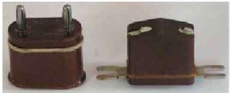
*В разряднике РВНШ-250 применен вентильный диск типа СН-2. Сопротивление диска, включенного последовательно с искровым промежутком, имеет резко выраженную вентильную характеристику: при повышении напряжения выше рабочего (пробивного - 850 В) сопротивление диска быстро уменьшается, а при снижении резко возрастает.*
