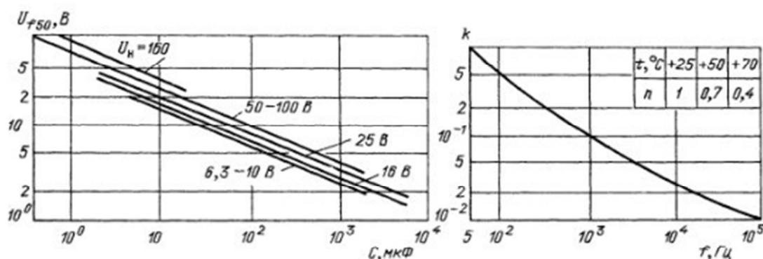
Зависимость допустимой амплитуды напряжения переменной составляющей пульсирующего тока от частоты, номинального напряжения и номинальной емкости:  $U_{f50}$  — допустимая амплитуда напряжения переменной составляющей пульсирующего тока на частоте 50 Гц;  $U_f$  — допустимая амплитуда напряжения переменной составляющей пульсирующего тока на частотах свыше 50 Гц;  $k$  — коэффициент снижения  $U_{f50}$  от частоты;  $n$  — коэффициент снижения  $U_{f50}$  от температуры
