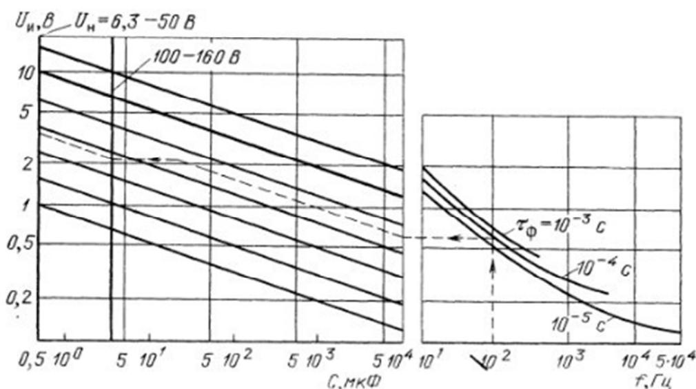
Зависимость допустимой амплитуды напряжения импульсного тока от частоты длительности фронта и номинальной емкости ( $U_{\text{н}} = 3,45 \text{ В}$  при  $C_{\text{н}} = 20 \text{ мкФ}$ ,  $U_{\text{н}} = 100 \text{ В}$ ,  $f = 10^2 \text{ Гц}$ ,  $\tau_{\text{ф}} = 10^{-4} \text{ с}$ )
