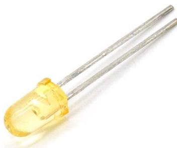
Светодиод АЛ172 инфракрасного цвета излучения. Предназначены для работы в качестве источников непрерывного или импульсного инфракрасного излучения в радиоэлектронной аппаратуре. Важными характеристиками для этих приборов являются быстрдействие и мощность излучения. Время нарастания импульса излучения – 100 нс, время спада импульса излучения – 100 нс.
