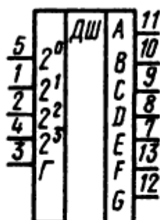
Условное графическое обозначение К514ИД1, КР514ИД1
