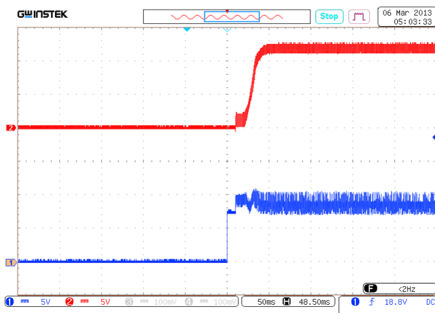
Рис. 28. Установление U_{\text{вых.ном}} с момента подачи сигнала ДУ (соединение выводов «ДУ» и «-ВХ» ). Луч 1 (синий) – входное напряжение. Масштаб 5 В/дел. Луч 2 (красный) – выходное напряжение. Масштаб 5 В/дел. Развертка 50 мс/дел.
