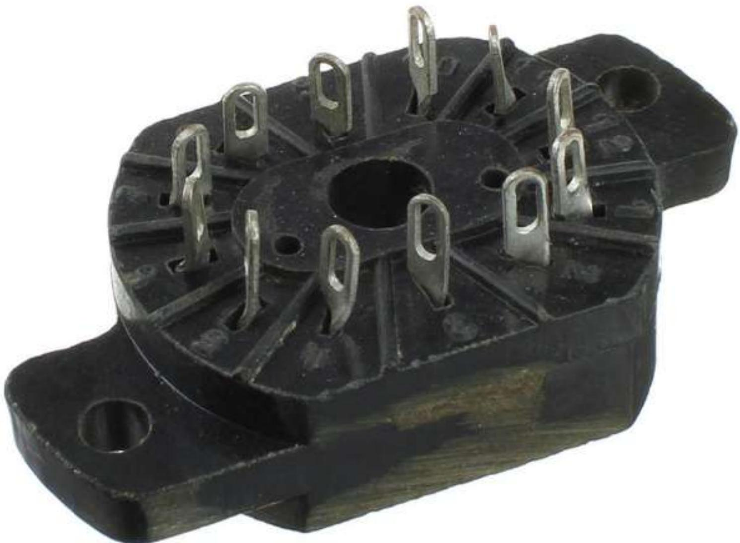
ПЛ31А-П ламповая панель применяется для вставления электровакуумных приборов (ЭВП) в радиоэлектронной аппаратуре. ПЛ31а-п используется для установки газоразрядных индикаторов ИН-12(а,б), ИН-15(а,б) и люминисцентных индикаторов ИВ-22.
