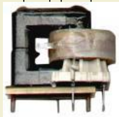
ТВС-90П4 фотография трансформатора.
