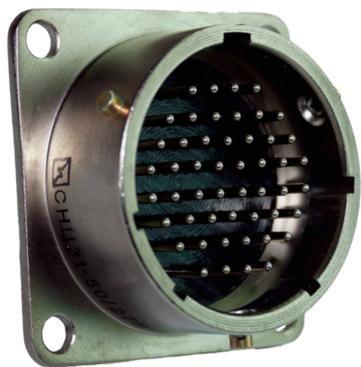
Байонетные субминиатюрные вилки цилиндрические типа **СНЦ30, СНЦ31** герметичные предназначены для работы в эл.цепях постоянного, переменного (частотой до 3 МГц) и импульсного токов при напряжении до 500В (ампл. значение) и токовых нагрузках до 6А.
