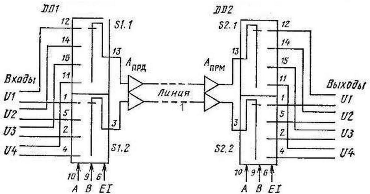
Микросхемы **К561КП1** (CD4052A) — мультиплексор, содержащий восемь каналов коммутации цифровых и аналоговых сигналов. У микросхемы К561КП1 (CD4052A) восемь каналов организованы как четырехканальный дифференциальный коммутатор. Мультиплексор имеет два вывода питания: положительное  $U_{u.n.c}$  подается на вывод 16, на вывод 7 может быть подано отрицательное напряжение —  $U_{u.n.э}$ .
