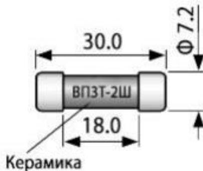
Габаритные и установочные размеры вставки плавкой ВПЗТ-2Ш.
