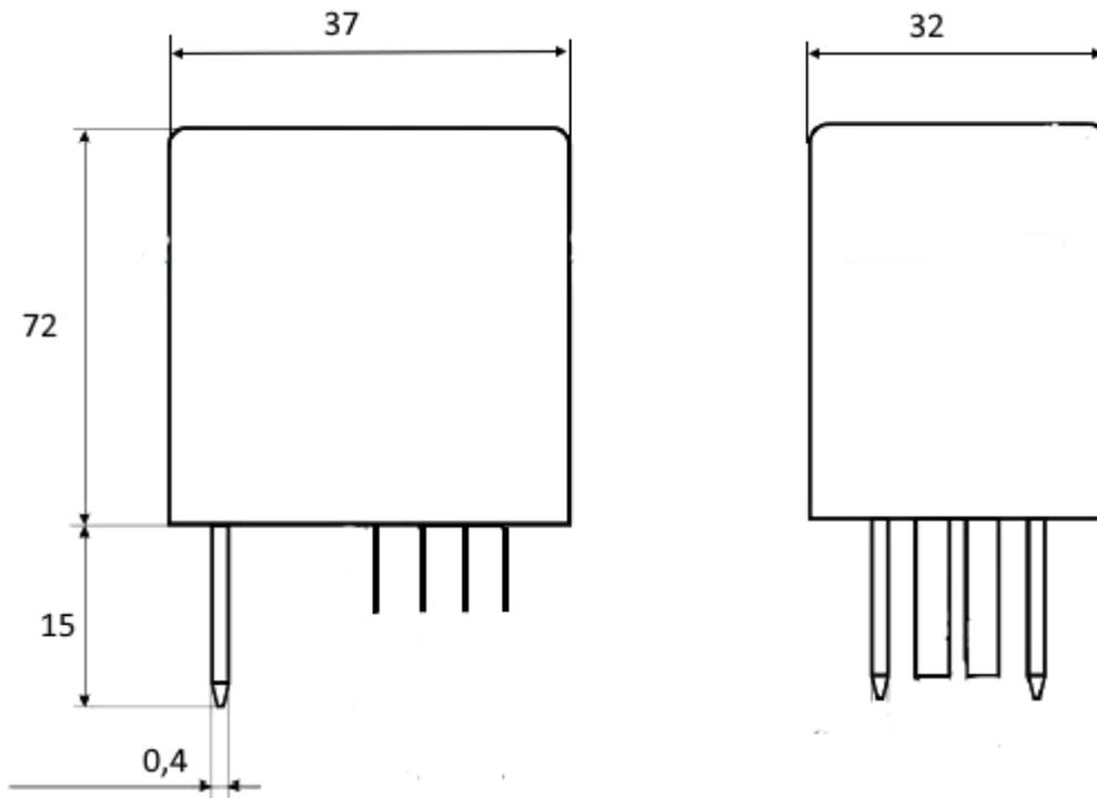
Магнитоэлектрическое реле типа РМЭ-2 предназначено для автоматической регулировки уровня передачи в аппаратуре дальней связи.
