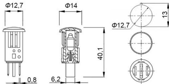
Лампочка неоновая в корпусе RUICHI MDX-14, оранжевая, 220 В, 15 мА - это газоразрядная лампа, состоит из баллона, заполненного разреженным инертным газом (неоном), и укрепленных внутри баллона двух дисковых или цилиндрических электродов.
