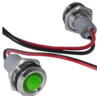
Индикатор антивандальный RUICHI GQ14WR-G, цвет зеленый, точечный излучатель, 12-24 В, 15 мА, гибкие выводы, никелированная латунь - это источник света для демонстрации электрических процессов в приборах. Конструктивно представляет собой модуль индикации, оснащенный контактным блоком, к которому припаиваются или присоединяются проводники.
