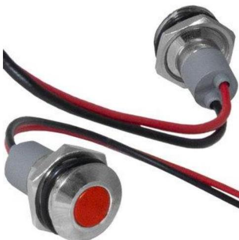
Индикатор антивандальный RUICHI GQ14WF-R, цвет красный, точечный излучатель, 12-24 В, 15 мА, гибкие выводы, никелированная латунь - это источник света для демонстрации электрических процессов в приборах. Конструктивно представляет собой модуль индикации, оснащенный контактным блоком, к которому припаиваются или присоединяются проводники.
