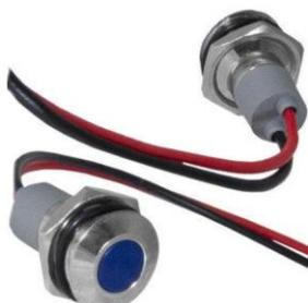
Индикатор антивандальный RUICHI GQ14WF-B, цвет синий, точечный излучатель, 12-24 В, 15 мА, гибкие выводы, никелированная латунь - это источник света для демонстрации электрических процессов в приборах. Конструктивно представляет собой модуль индикации, оснащенный контактным блоком, к которому припаиваются или присоединяются проводники.
