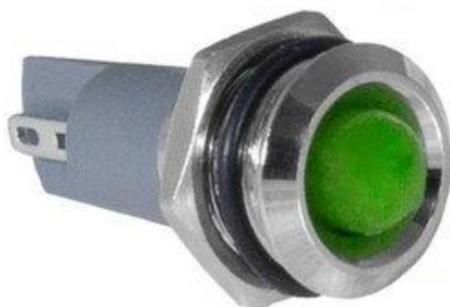
Индикатор антивандальный RUICHI GQ14PR-G, цвет зеленый, точечный излучатель, 12-24 В, 15 мА, гибкие выводы, никелированная латунь - это источник света для демонстрации электрических процессов в приборах. Конструктивно представляет собой модуль индикации, оснащенный контактным блоком, к которому припаиваются или присоединяются проводники.
