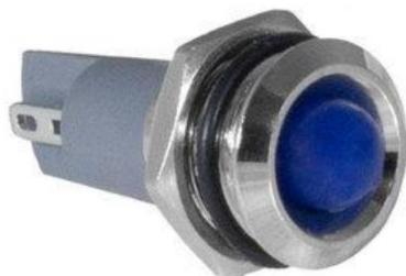
Индикатор антивандальный RUICHI GQ14PR-B, цвет синий, точечный излучатель, 12-24 В, 15 мА, гибкие выводы, никелированная латунь - это источник света для демонстрации электрических процессов в приборах. Конструктивно представляет собой модуль индикации, оснащенный контактным блоком, к которому припаиваются или присоединяются проводники.
