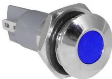
Индикатор антивандальный RUICHI GQ14PF-B, цвет синий, точечный излучатель, 12-24 В, 15 мА, гибкие выводы, никелированная латунь - это источник света для демонстрации электрических процессов в приборах. Конструктивно представляет собой модуль индикации, оснащенный контактным блоком, к которому припаиваются или присоединяются проводники.
