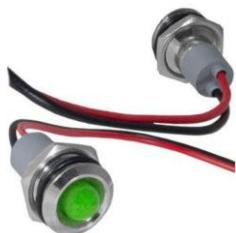
Индикатор антивандальный RUICHI GQ12WR-G, цвет зеленый, точечный излучатель, 12-24 В, 15 мА, гибкие выводы, никелированная латунь - это источник света для демонстрации электрических процессов в приборах.
