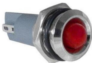
Индикатор антивандальный RUICHI GQ12PR-R, цвет красный, точечный излучатель, 12-24 В, 15 мА, гибкие выводы, никелированная латунь - это источник света для демонстрации электрических процессов в приборах.
