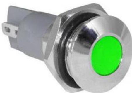
Индикатор антивандальный RUICHI GQ10PF-G, цвет зеленый, точечный излучатель, 12-24 В, 15 мА, гибкие выводы, никелированная латунь - это источник света для демонстрации электрических процессов в приборах. Конструктивно представляет собой модуль индикации, оснащенный контактным блоком, к которому припаиваются или присоединяются проводники.
