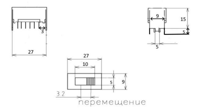
Переключатель ПД11-6 движковый. Предназначен для коммутации электрических цепей постоянного и переменного токов в электронной аппаратуре.
