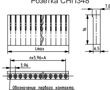
Рисунок 2а Контакты на несущей технологической ленте
