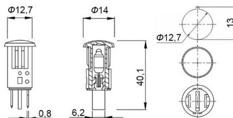
Лампочка неоновая в корпусе RUICHI MDX-14, зеленая, 220 В, 15 мА - это газоразрядная лампа, состоит из баллона, заполненного разреженным инертным газом (неоном), и укрепленных внутри баллона двух дисковых или цилиндрических электродов.
