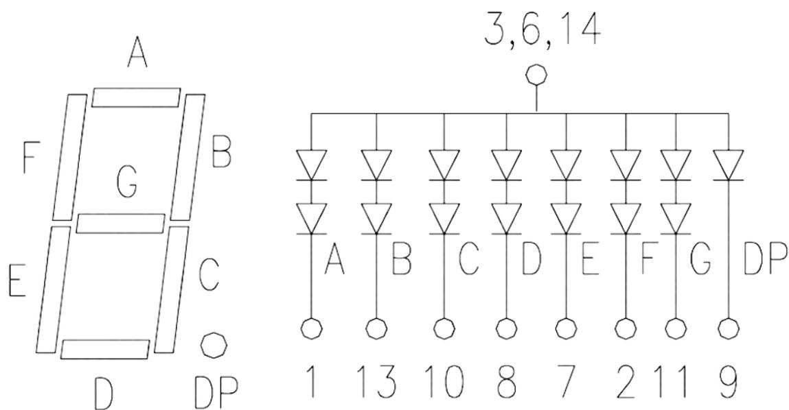
KEM-1101BR (Red) Индикатор цифровой красный - это прибор для отображения значения числовой величины в цифровом виде. Индикаторы имеют семь сегментов и десятичную точку, излучающие свет при подаче прямого тока. Различные комбинации элементов, обеспечиваемые внешней коммутацией, позволяют воспроизвести любую цифру от 0 до 9.
