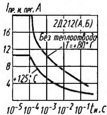
Зависимости допустимого прямого тока перегрузки от длительности импульса
