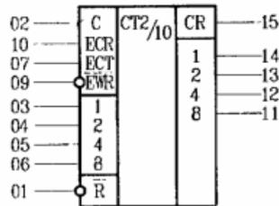
Микросхема КР1533ИЕ9 представляет собой четырехразрядный десятичный счетчик с асинхронным сбросом. В микросхеме предусмотрена возможность предварительной записи информации. Работа КР1533ИЕ9 определяется тремя управляющими входами ECT, ECR, EWR. Низкий уровень напряжения на входе EWR разрешает предварительную установку счетчика в состояние, определяемое логическими уровнями на информационных входах. Установка проводится синхронно по переднему фронту синхрипульса.
