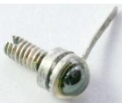
Арсенидогаллиевые мезаэпитаксиальные излучающие диоды АЛ119А, АЛ119В, ЗЛ119А, ЗЛ119Б и мезаэпитаксиальные на основе арсенида галлия–алюминия излучающие диоды АЛ119Б, АЛ119Г в металлостеклянном корпусе КДИ-16 предназначены для работы в качестве источников инфракрасного излучения в радиоэлектронной аппаратуре.
