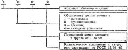
Пример условного обозначения транзисторного элемента логической группы для реализации функции «ИЛИ—НЕ», климатического исполнения У, категории размещения 2: Элемент транзисторный типа Т-101 У2 ГОСТ 5.2177—74.
