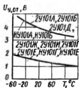
Зависимости отпирающего постоянного напряжения управления от температуры
