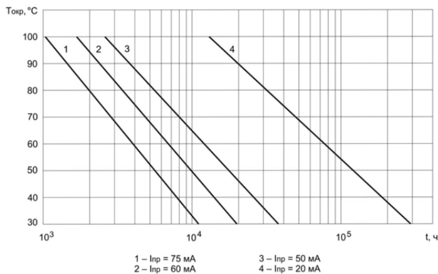
Зависимость минимальной наработки диодов типа АЛ115Б, АЛ115В, ЗЛ107А, ЗЛ107Б
