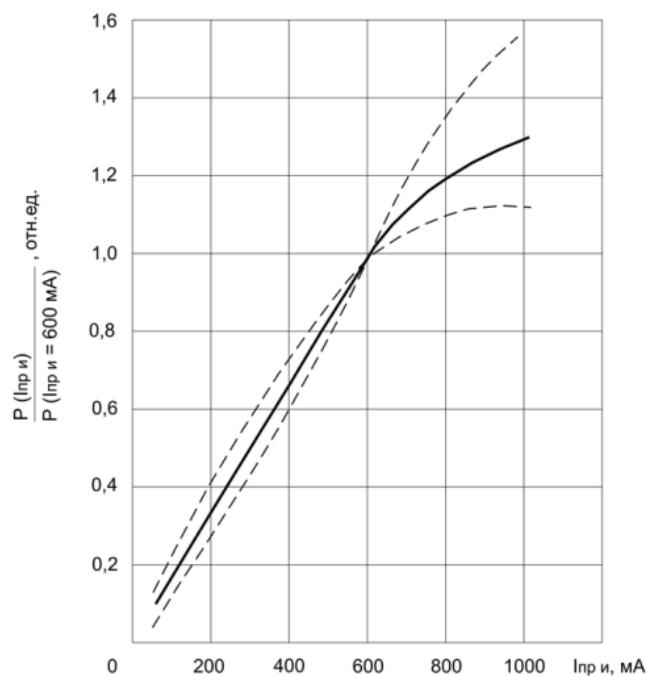
Зависимость минимальной наработки диодов типа АЛ115А от режима эксплуатации
