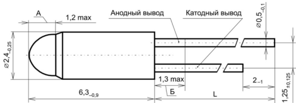
Длина выводов L в зависимости от варианта исполнения диода равна  $12 \pm 0,9$  мм (АЛ115-01, ЗЛ115-01, ЗЛ107-01) или  $28 \pm 2$  мм (АЛ115, ЗЛ115, ЗЛ107)
