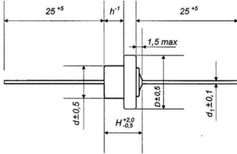
Габаритные размеры и рисунок конденсаторов
