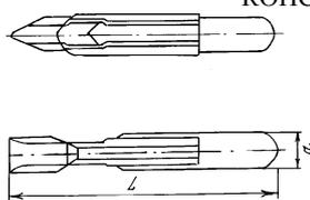
Рис. 1. Лампы накаливания коммутаторные типов КМ6-50, КМ12-90, КМ24-35, КМ24-90, КМ48-50, КМ60-50
