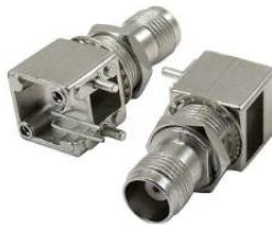
Высокочастотный разъем – конструкция, предназначенная для подсоединения различных электронных устройств к электрическим цепям для осуществления согласованной надежной передачи сигналов высокой частоты. При этом в местах соединения потери сводятся к минимуму. Высокочастотные разъемы могут иметь обычные или изолированные корпусы. По способу соединения они могут быть: с байонетным соединением или с резьбовым соединением.
