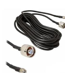
Кабельная сборка RG-58 длиной 3 метра с напаянными разъемами N-male (вилка) и SMA-male (вилка) резьбового сочленения. Кабельные сборки широко применяются в системах усиления сотовой связи и интернета для соединения репитера с антеннами. Также эти кабельные сборки используются для подключения к принимающим антеннам роутеров, GSM-телефонов и GSM-шлюзов.
