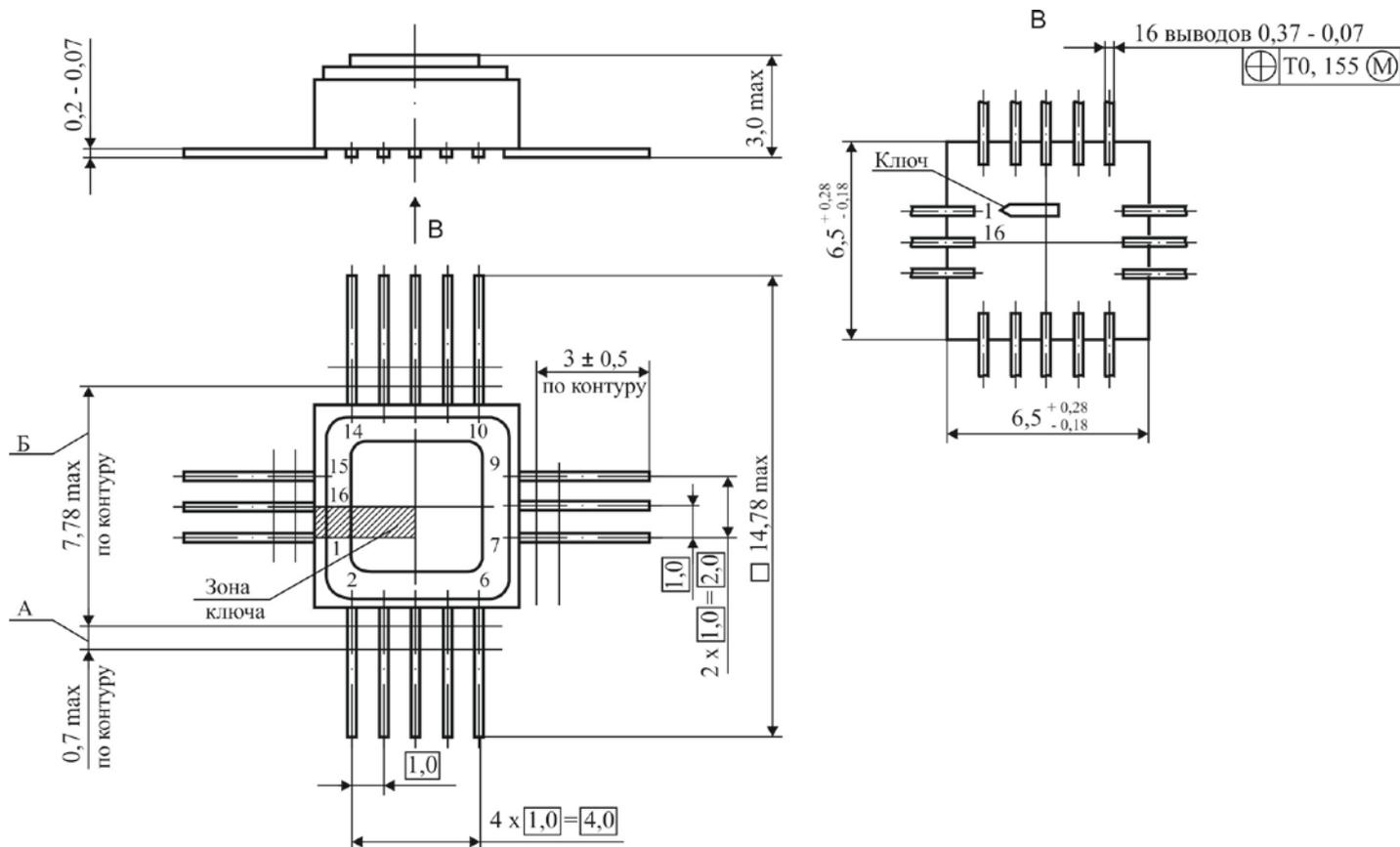
1. А - длина вывода, в пределах которой производится контроль смещения плоскостей симметрии выводов от номинального расположения.
