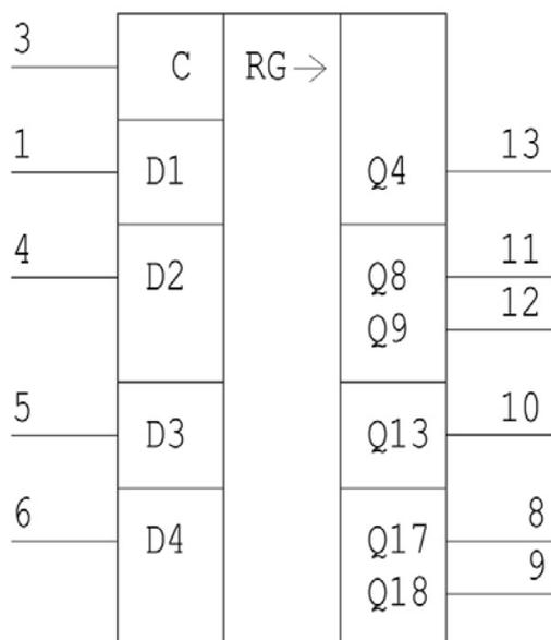
**Т а б л и ц а 1. Назначение выводов микросхем 564ИР1В.**
