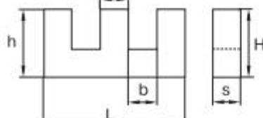
Выпускаются ШП-образные сердечники с зазором для снижения влияния подмагничивающего поля и расширения рабочего диапазона частот, а также низкопрофильные сердечники типа Ш и ШП для изготовления малогабаритных микромодульных источников питания с частотой до 1 МГц.
