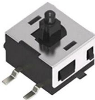
Микропереключатель RUICHI DS-005, 0.1 А, 30 В, 500 мОм, 50000 циклов, 3x4.1x3.4 мм, -40..+70°C представляет собой коммутационное устройство с механическим приводом. Он используется в качестве исполнительных устройств дистанционного управления, а также в качестве базового элемента для ряда коммутирующих изделий: кнопок, кнопочных, клавищных и других переключателей.
