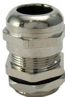
Кабельный ввод PG25M, диаметр кабеля 15-22 мм, IP68, никелированная латунь, уплотнитель EPDM, -40...+100 °С позволяет вводить в электрооборудование электрические и оптоволоконные кабели. Благодаря вводу обеспечивается надежная фиксация и герметизация соединения для обеспечения необходимой степени защиты от неблагоприятных факторов внешней среды.
