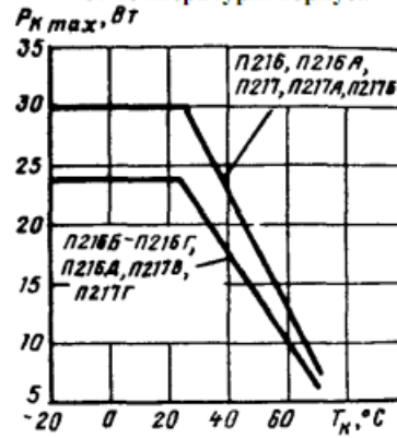
Зависимость предельной допустимой рассеиваемой мощности коллектора от температуры корпуса
