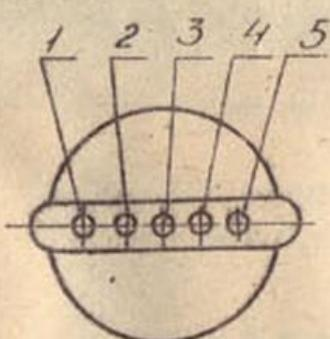
Обозначения выводов даны при рассмотрении лампы со стороны ножки.
