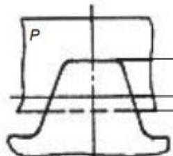
Рабочая зона воздействия управляющего элемента (положение переключающей пластины в момент срабатывания).
