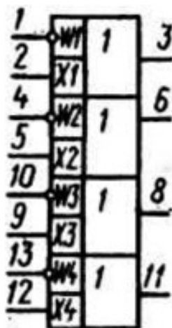
Условное графическое обозначение К533ЛП8
