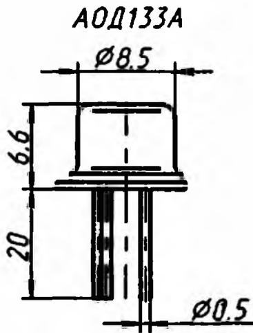
Оптопара диодная, состоящая из арсенидгаллиевого излучателя и кремниевое фотоприемника, изготовленных по эпитаксиальной технологии, иммерсионной среды и внутреннего экрана между ними. Предназначена для использования в качестве элементов гальванической развязки электрических цепей. Выпускается в металлоглазном корпусе.
