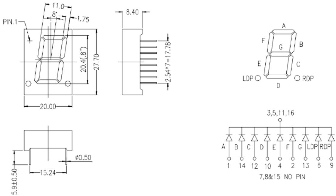
KEM-8102AG (Green) Индикатор цифровой зеленый - это прибор для отображения значения числовой величины в цифровом виде. Имеют фиксированный набор элементов отображения (сегментов), расположенных как произвольно, так и сгруппированных по несколько цифр.
