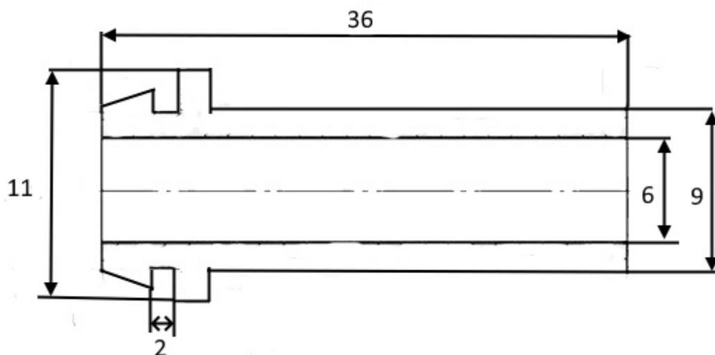
Втулка соединения кабеля RUICHI, диаметр 6 мм, длина 36 мм, -20...+120 °С, материал резина EPDM, черная используется для соединения сетевого кабеля с вилкой в электроинструментах, защищая электрический провод от перегиба.
