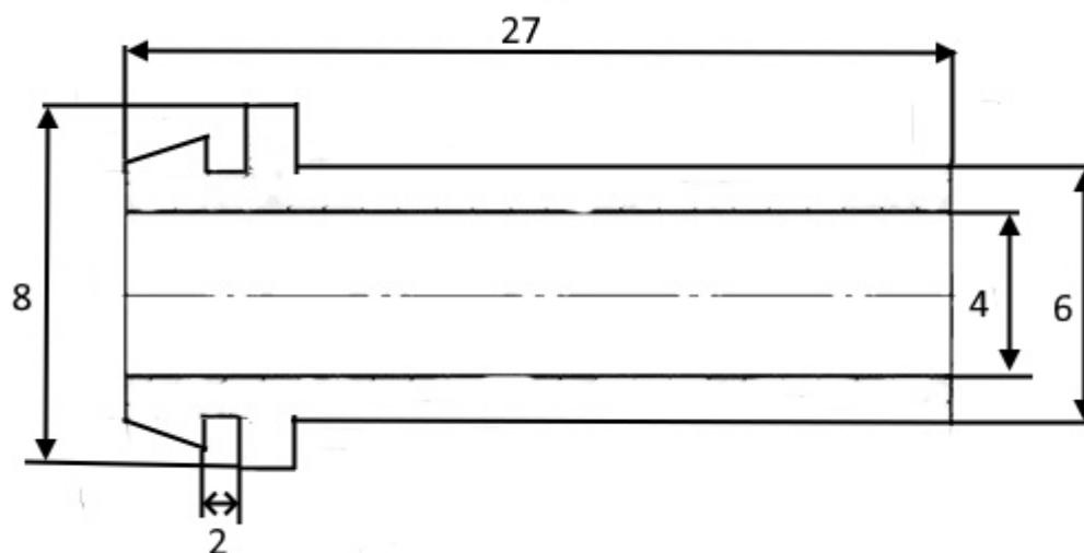
Втулка соединения кабеля RUICHI, диаметр 4 мм, длина 27 мм, -20...+120 °С, материал резина EPDM, черная используется для соединения сетевого кабеля с вилкой в электроинструментах, защищая электрический провод от перегиба.
