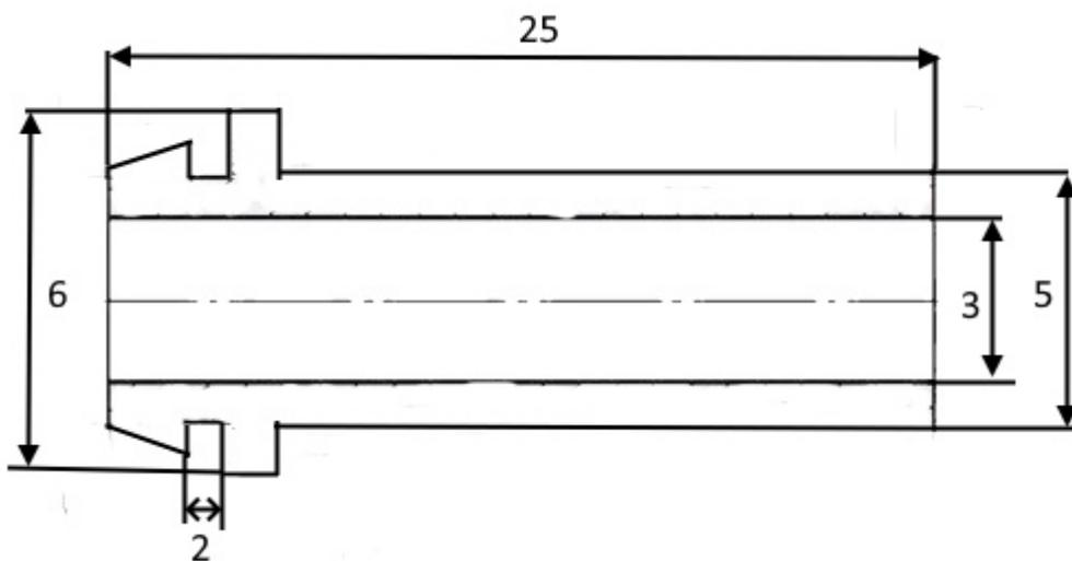
Втулка соединения кабеля RUICHI, диаметр 3 мм, длина 25 мм, -20...+120 °С, материал резина EPDM, черная используется для соединения сетевого кабеля с вилкой в электроинструментах, защищая электрический провод от перегиба.
