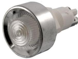
Лампочка неоновая в корпусе RUICHI N-836-W, 220 В, белая - это газоразрядная лампа, состоит из баллона, заполненного разреженным инертным газом (неоном), и укрепленных внутри баллона двух дисковых или цилиндрических электродов.
