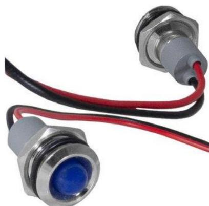
Индикатор антивандальный RUICHI GQ10WR-B, цвет синий, точечный излучатель, 12-24 В, 15 мА, гибкие выводы, никелированная латунь - это источник света для демонстрации электрических процессов в приборах. Конструктивно представляет собой модуль индикации, оснащенный контактным блоком, к которому припаиваются или присоединяются проводники.
